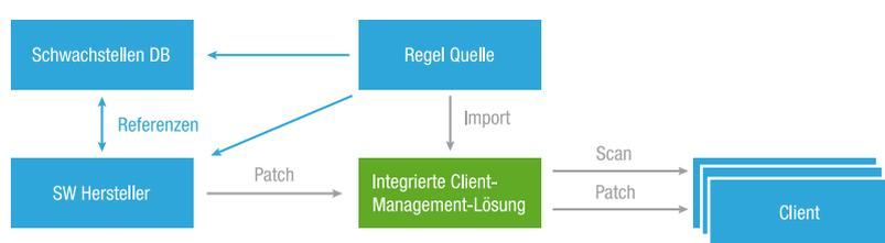
Komponenten und Abläufe einer integrierten automatisierten Schwachstellenmanagement-Lösung
