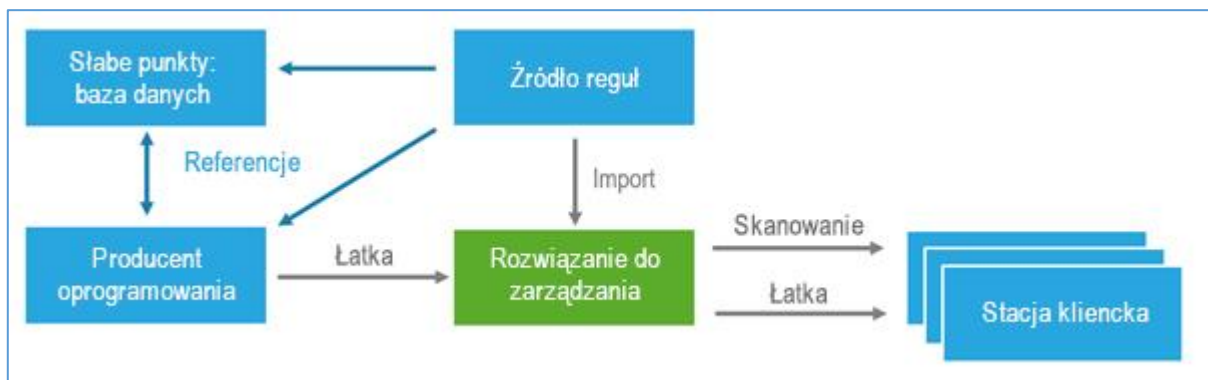
Importowanie reguł i łatek, skanowanie punktów końcowych w poszukiwaniu luk w zabezpieczeniach oraz scentralizowane wdrażanie łatek
